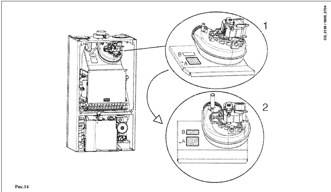
У деяких випадках, при установці системи відведення відпрацьованих газів по роздільним трубах, котел може почати вібрувати. При цьому можливе блокування повітряного пресостата (код помилки E03 на дисплей котла).
