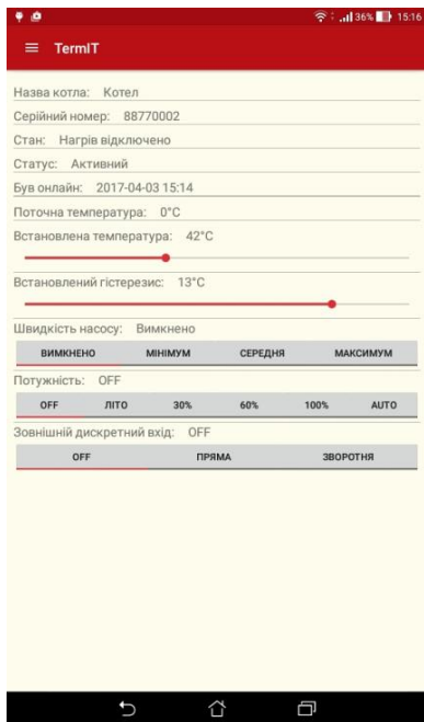
Рис.8.5.11. Налаштування основних параметрів котла.
